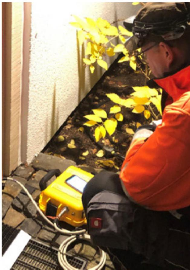
*Kontrollmessung der Bodenschwinggeschwindigkeit an Gebäuden entlang der Seismik-Messlinie.*
