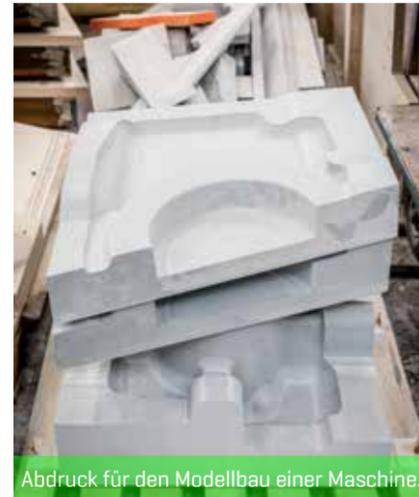
Abdruck für den Modellbau einer Maschine.
