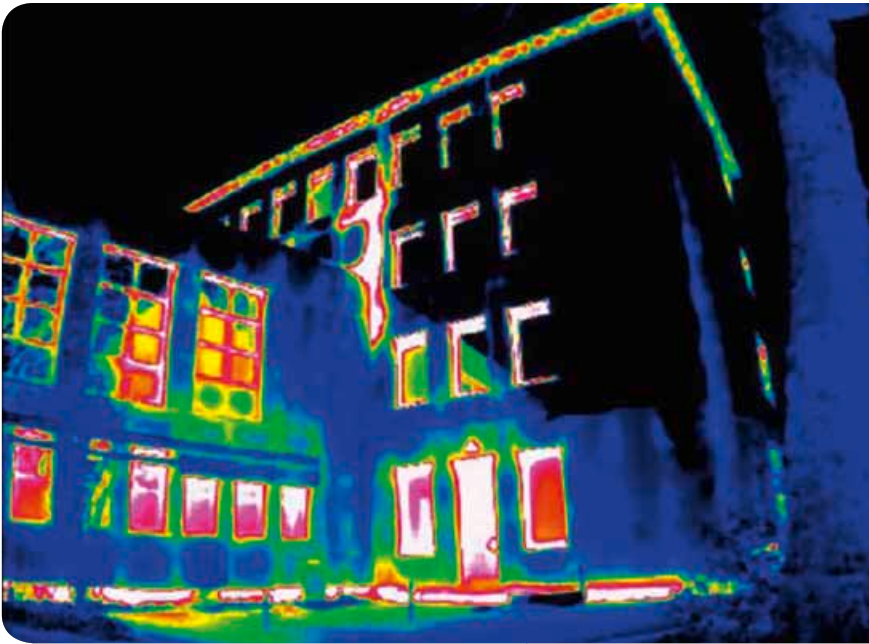
Aktiv werden: Die Farben Gelb und Rot signalisieren Wärmeverluste.
